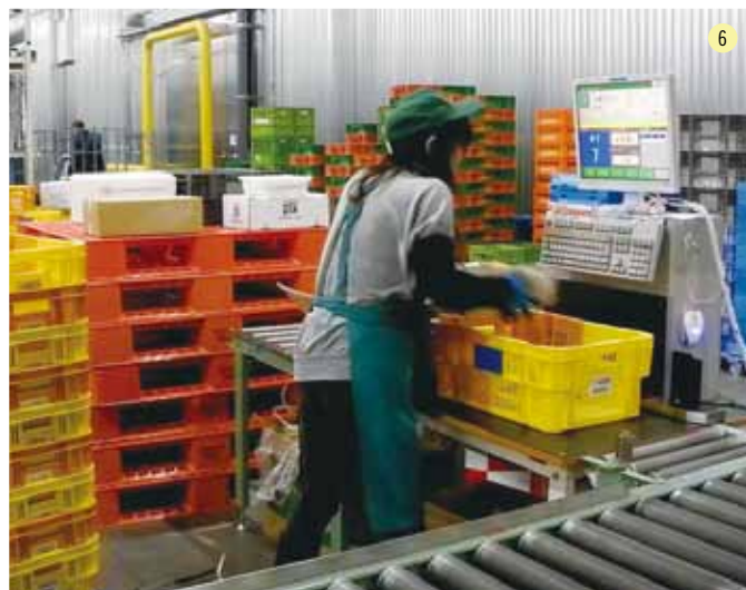
⑥⑦中仕分けでGASユニットへの搬送先を設定。⑦の画面表示は数字の5だが、漢数字でも表示される
