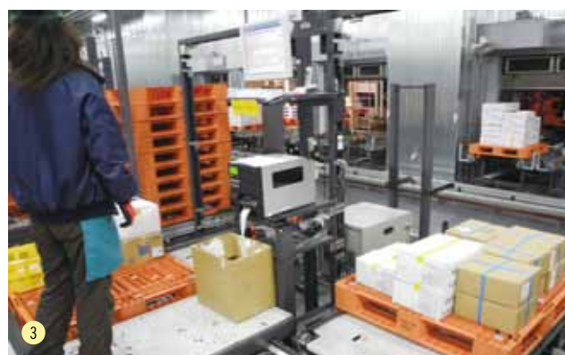
③自動倉庫から出荷されるケース品。ピッキングステーションを増設したほか，商品特性に合わせ棚は食品ケース3段積みの高さに設定。写真ではわかりにくい，ピッキングステーションの幅にもこだわり，作業しやすい環境を創出した。中央のプリンタはサトー製
