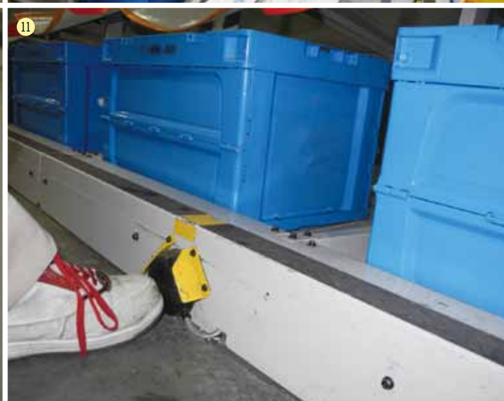
⑧～⑩GASの作業はスピーディで流れるようだ。作業が開始されたら、ゲートが開き、必要数量をシステムが音声指示。的確で間違いのない作業が実現する。写真—は、各ユニットに2つ設置されているモニター画面。目で場所を確認することもできる ⑪GASの最下段。ステップを10cm高くして、小柄な女性の踏み台としても使用可能。フットスイッチは安全靴着用を前提に、足を滑らせて押せるように改良されている
