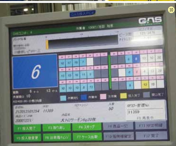
⑧～⑩GASの作業はスピーディで流れるようだ。作業が開始されたら、ゲートが開き、必要数量をシステムが音声指示。的確で間違いのない作業が実現する。写真—は、各ユニットに2つ設置されているモニター画面。目で場所を確認することもできる ⑪GASの最下段。ステップを10cm高くして、小柄な女性の踏み台としても使用可能。フットスイッチは安全靴着用を前提に、足を滑らせて押せるように改良されている
