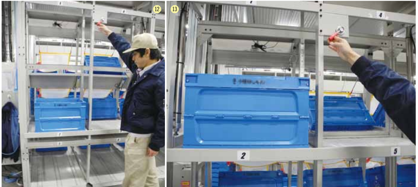
⑫⑬ 検討に検討を重ねられ、考え出されたエア昇降。これにより女性でも荷降ろしが可能となった
