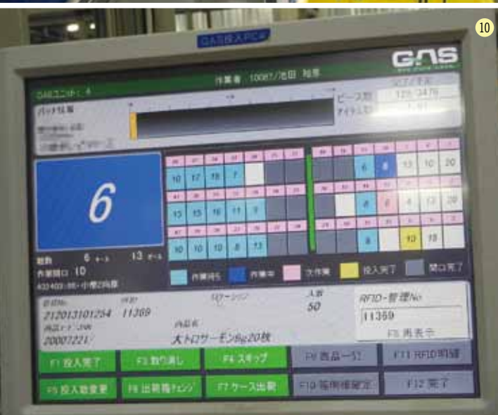
8～10 GASの作業はスピーディで流れるようだ。作業が開始されたら、ゲートが開き、必要数量をシステムが音声指示。的確で間違いのない作業が実現する。写真—は、各ユニットに2つ設置されているモニター画面。目で場所を確認することもできる
