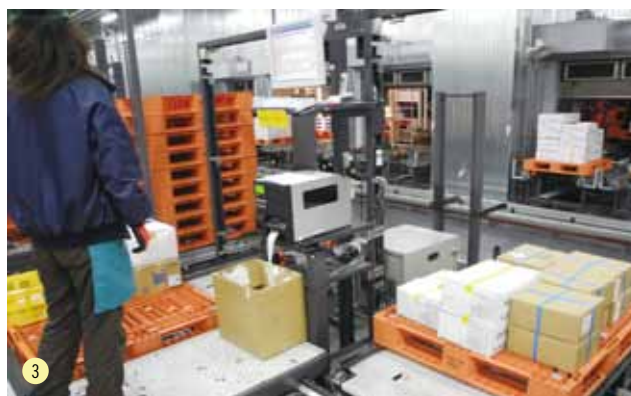
③ 自動倉庫から出荷されるケース品。ピッキングステーションを増設したほか、商品特性に合わせて棚は食品ケース3段積みの高さに設定。写真ではわかりにくいですが、ピッキングステーションの幅にもこだわり、作業しやすい環境を創出した。中央のプリンタはサトー製
