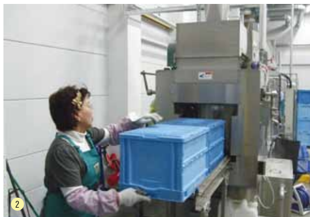
② 返却されたオリコンはクレオ製大型ライン洗浄機で洗浄。1時間あたり1500ケース/hを処理する
